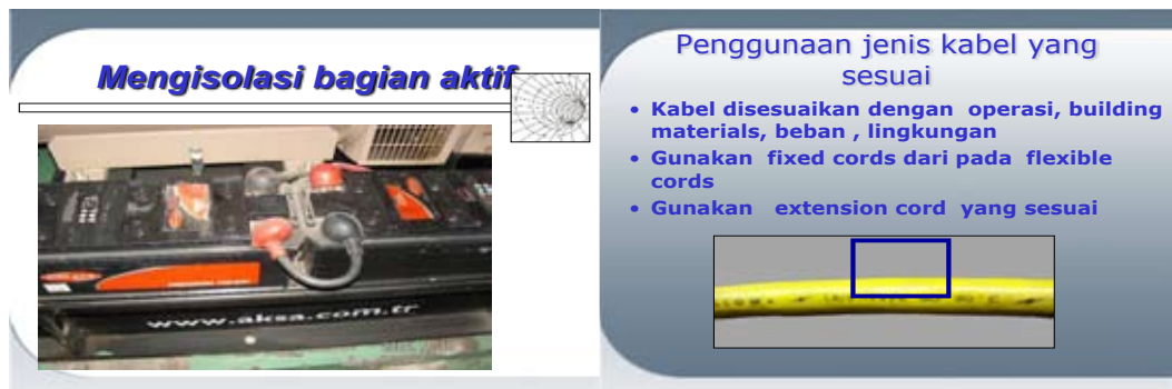
Gambar 2 Semua bagian aktif/bertegangan diisolasi sehingga tidak ada potensi arus kejut
